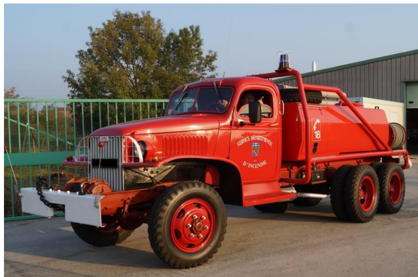
Camion GMC « Feu de forêt » de 1943 transformé en véhicule de secours dans les années 60. Sa citerne pouvait contenir 3 000 litres d'eau
