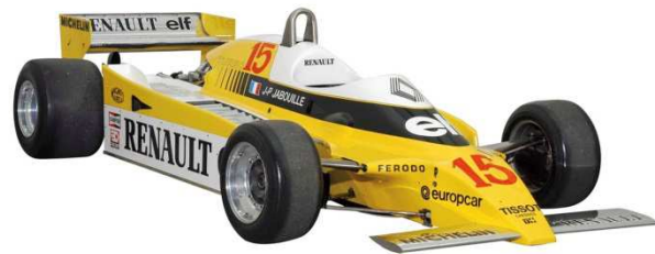
Modèle exposé : F1 Renault RS 14 (4 e châssis construit de la série RS 10) – Année 1979 - moteur 6 cylindres en V en position centrale, 1492 cm 3 turbocompressé - 520 ch
